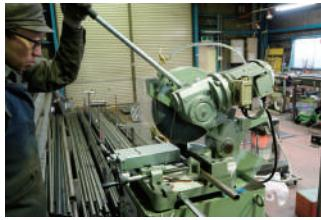
まずは「制限(切断機付属のスケール)」の長さを設定し、鉄パイプをセット。スイッチを入れると円形の歯が勢いよく回り、同時に冷却と摩耗予防用の切削油が流れ出します。「スーッ」とレバーを降ろし、鉄パイプに歯をあてます。カクっという手応えと共にレバーが軽くなったら切断終了です。
