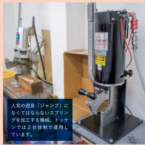
人気の遊具「ジャンプ」になくてはならないスプリングを加工する機械。トッケンでは2台体制で運用しています。
