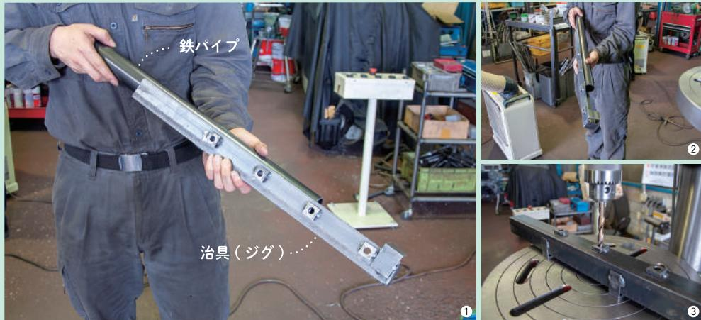
治具(ジグ)は部品を固定し、加工するときのガイドとなるものです。鉄製遊具はそれぞれ専用の治具があり、それを使用して溶接や曲げなどの加工を行っています。この治具ももちろん鉄工スタッフのオリジナルです。写真はなわとびポールの穴あけ用の治具(①)。材料のパイプを治具に添わせて入れて固定し、(②)穴のガイドに向かってドリルを入れます(③)。
